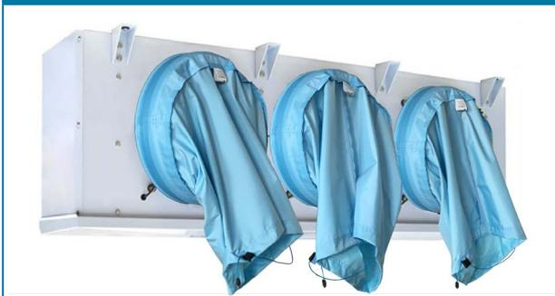
1. Конец текстильной насадки открыт, что позволяет воздухоохладителю работать в обычном режиме. Длина текстильной насадки зависит от диаметра вентилятора и, как правило, не превышает одного метра. Расход через охладитель может быть очень незначительно ограничен в зависимости от заданных характеристик вентилятора и степени регулировки демпфера.
